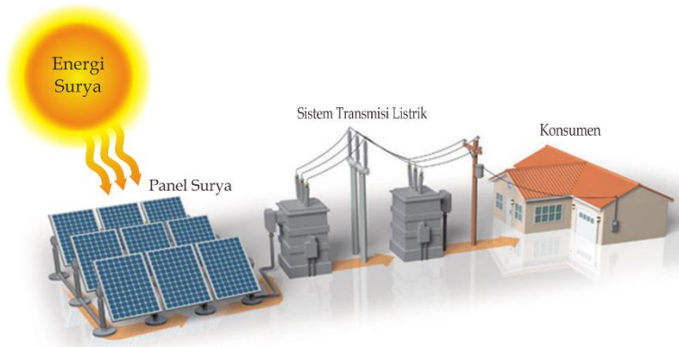
Gambar 6 Cara Kerja Pembangkit Listrik Tenaga Surya 133
