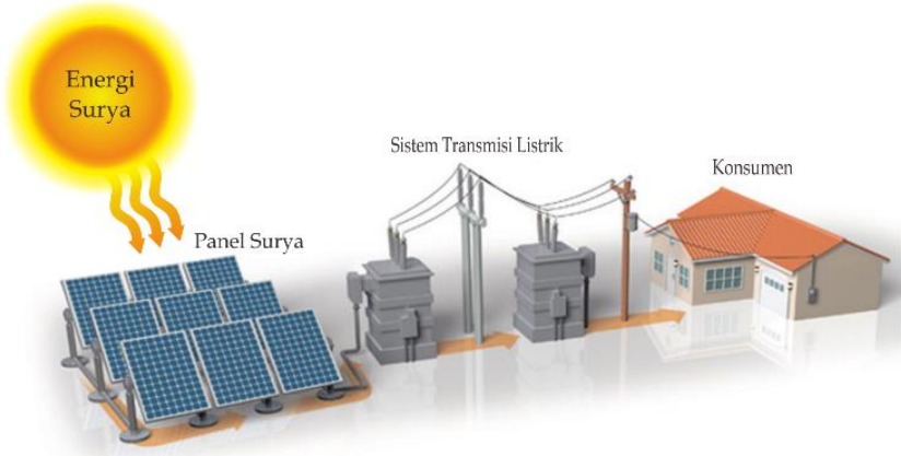
Gambar 9 Cara Kerja Pembangkit Listrik Tenaga Surya 174
